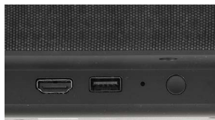
Panel przyłączeniowy jest ekstremalnie skromny, ale zasadniczo praktyczny – z jednym wyjściem HDMI (eARC). Znajdujące się obok gniazdo USB służy do celów serwisowych.
