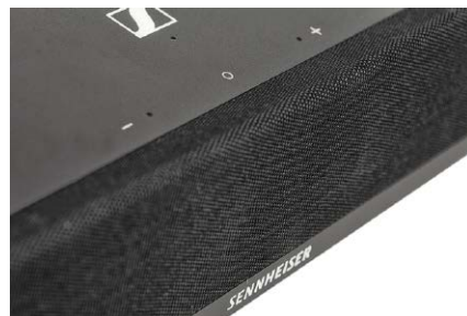
Tuż przy krawędzi przedniej ścianki umieszczono sensory dotykowe podstawowych funkcji.
