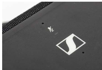
W okolicach logo widać szczeliny z mikrofonami systemu kalibracyjnego – to rzadkie wyposażenie soundbarów tej klasy.
